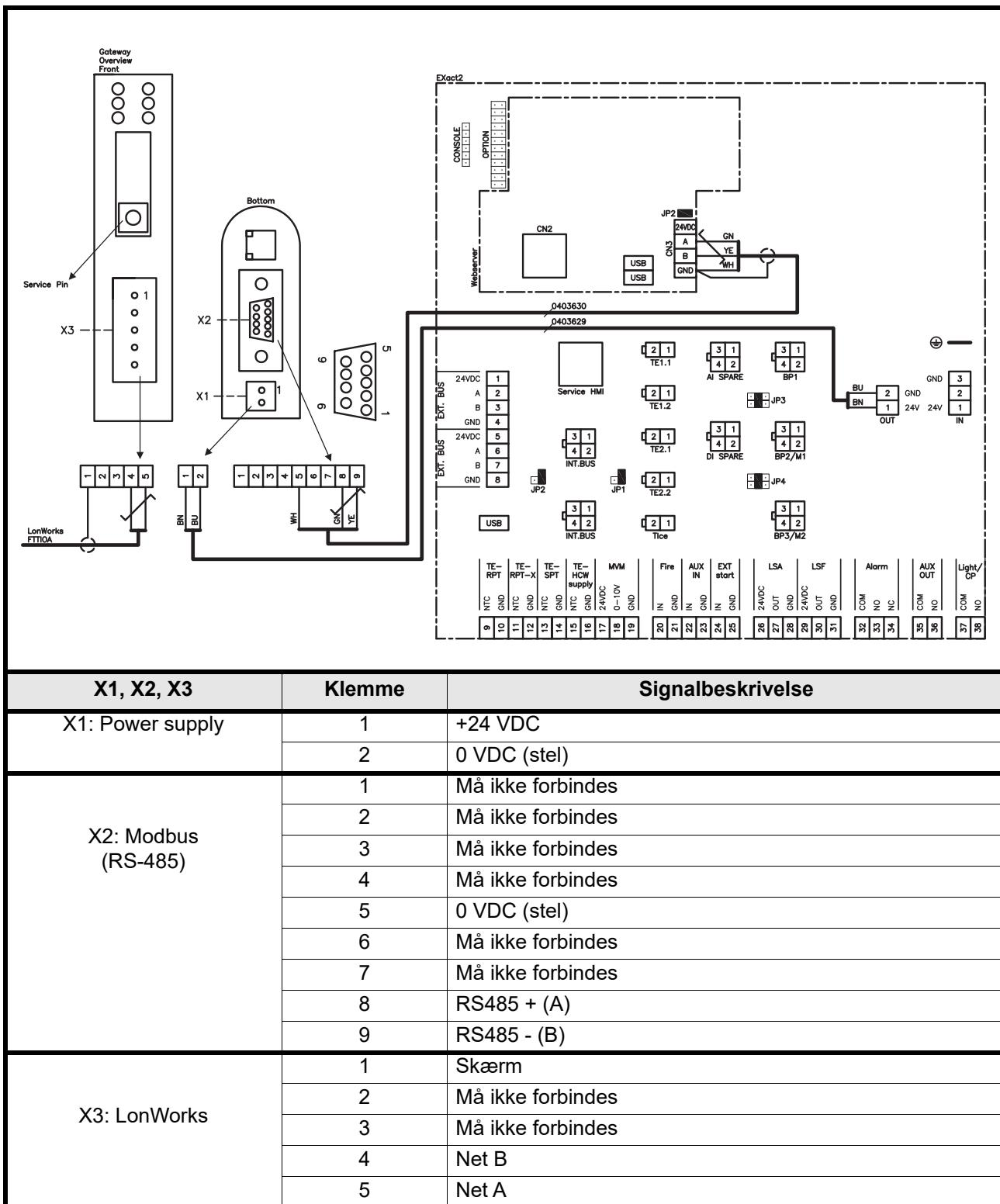
LON-buskablet monteres i LON-gateway'ens X3 klemrække som vist på diagrammet.
