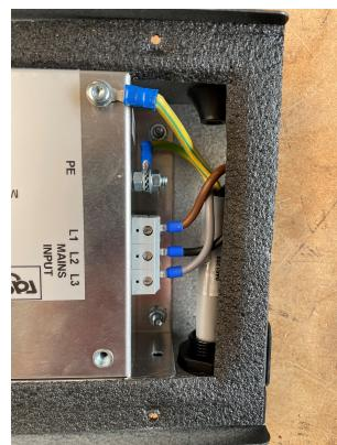
Il est recommandé d'utiliser un tube de borne pour connecter les 2 fils avant de les placer dans la même borne.
