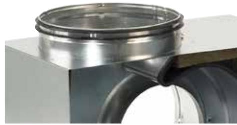
BESF boxventilatorer er lavet af Aluzink AZ185 klasse C4 iht. EN/ISO12944-2 og lyd- og kondensisolering med 30 mm mineraluld.
