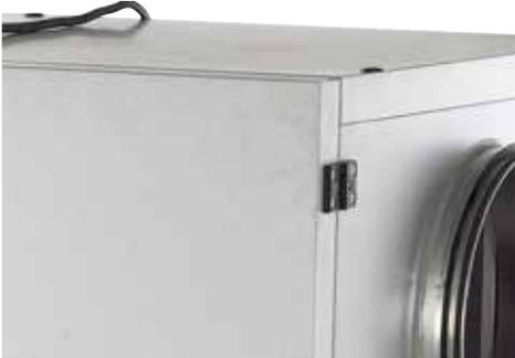
Kabinetterne er lavet af Aluzink AZ185 klasse C4 iht. EN/ISO 12 944-2 og isoleret med 50 mm mineraluld. Det medfører et lavt lydniveau til omgivelserne/ opstillingsrummet. Panelkonstruktionen minimerer dannelsen af kuldebroer i aggregatet.
