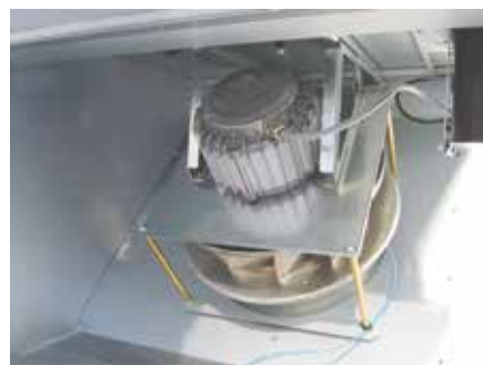
Motorsektionerne er monteret i svingningsdæmpere, hvilket betyder mindre støj og vibrationer i kanalerne, og man behøver ikke montere flexforbindelser mellem aggregat og kanalsystem. Motorsektionerne er udtrækkelige for nemmere service. Motorerne er type EC med meget høj virkningsgrad, der lever op til EcoDesign direktivets krav.
